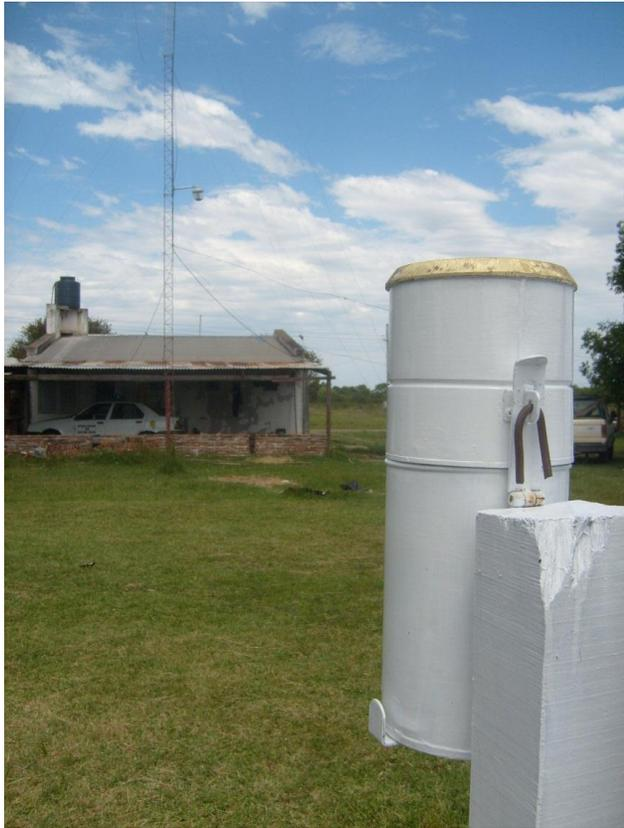
El cuerpo de retención se compone de un recipiente cilíndrico ensamblado al anterior. Este cuerpo tiene, la finalidad de almacenar el agua de lluvia.
